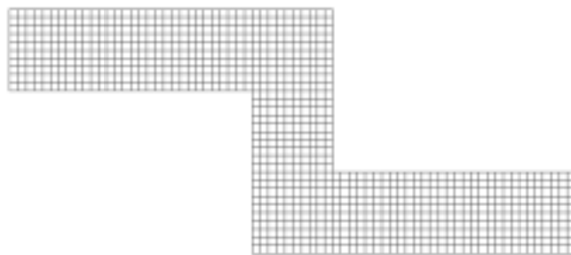
Sl. 8. Računska mreža pri modeliranju toka viskoelastične tekočine v kanalu oblike Z Fig. 8. Computational mesh for simulation of viscoelastic fluid in Z channel
