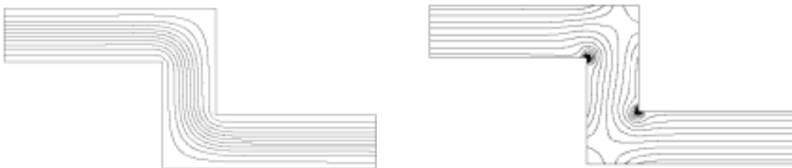
Sl. 9. Tok nenevtonske viskoelastične tekočine v kanalu oblike Z modelirane z zgornje konvektivnim Maxwellovim reološkim modelom ( \lambda_1=0,06 ); tokovnice (levo) in izošte vrtinčnosti (desno) Fig. 9. Non-Newtonian viscoelastic fluid flow in Z channel. Upper-convected Maxwell rheological model with ( \lambda_1=0.06 ); streamlines (left) and vorticity lines (right)
