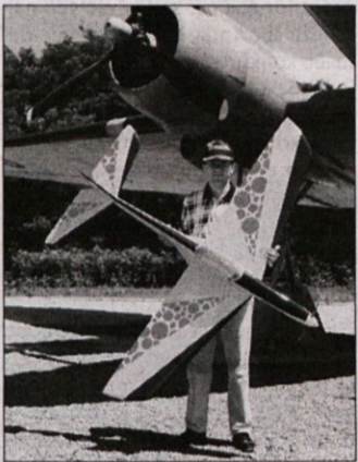
NAJUSPEŠNEJŠI - Najuspešnejši tekmovalac Modelarskega društva Igor Makovec s svojim akrobatskim modelom Matador razpetine kril 195 cm in dolžine 165 cm. Model, tehtal 3 in pol kilograma, poganja dvotaktni motor Webra 10 ccm in pri tem razvija 2,2 konjski sili.
