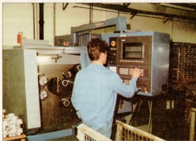
Eden najnovjših strojev, ki so jih kupili v tem letu: dvovretenska CNC stružnica, za katero so plačali 330 tisoč mark. Foto: Langerholc
