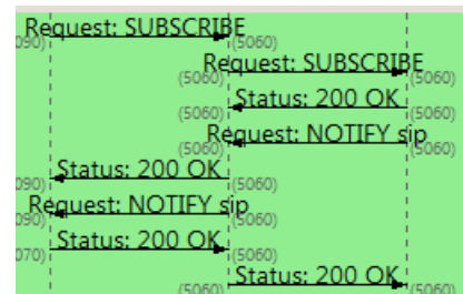
Slika 6: Naročanje s SUBSCRIBE za Event: presence , ki se pošlje za vsakega uporabnika, vpisanega v imeniku (od S-CSCF, AS1 do zunanjega PS)
