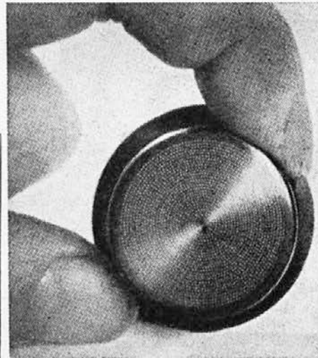
Šoba, mojstrovina umetne obrti (zgoraj). Iz celuloze pripravijo židko tekočino viskozo, ki jo stisnejo skozi šobo (spodaj).
