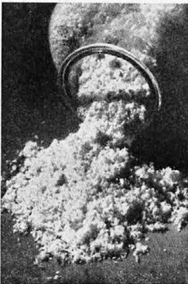
Na desni: V velikih balah se vskladišći čista celuloza. Na levi: Celuloza se namaka v lugu, nato pa raztrga v skrivenćeno maso.
