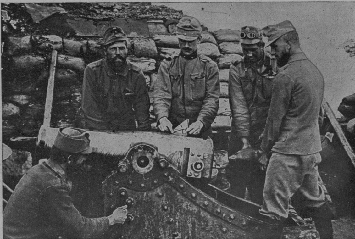
Možnar — metalec min in bomb s strupenimi plini — uravnava v pravo lego. Z vodno tehniko določajo, koliko naj bo cev nagnjena oziroma vodoravna, da bo učinek strela popoln, da se bo izstreljena mina razpočila baš pred sovražnikom. (Čitaj članek „Strupeni plini in saniteji“ na strani 254.)
