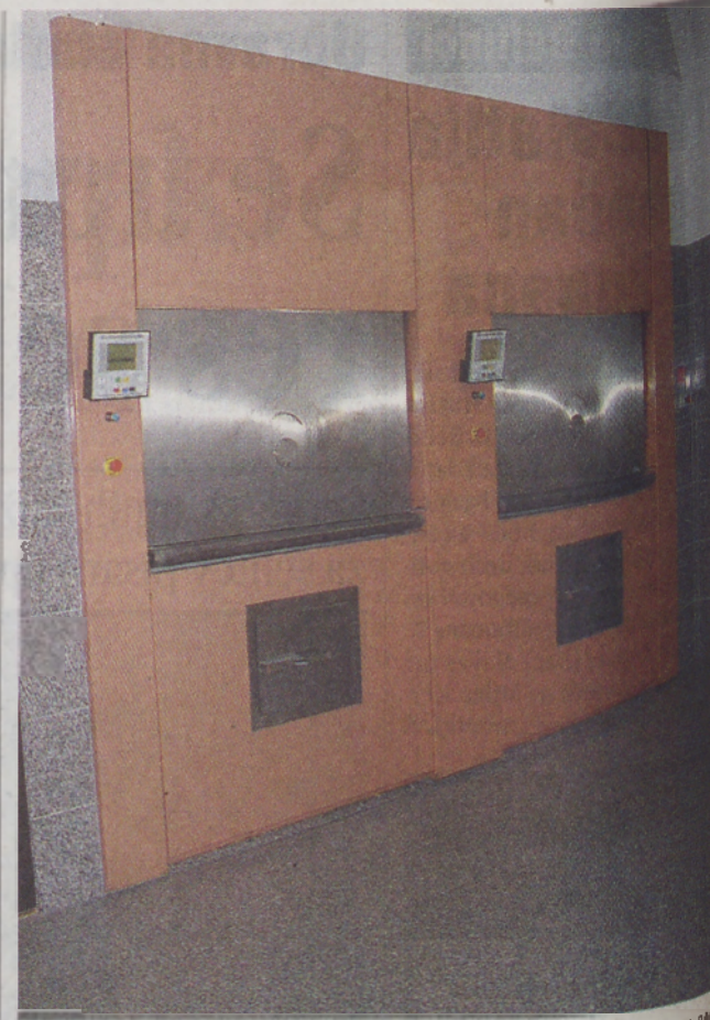
V Mariboru imajo dve plinski peči. Upepeljevanje (pri temperaturi do 1.300 stopinj) traja do dve uri in pol.
