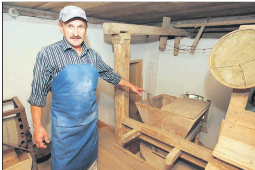
V mlinu: v odprtino mlinar vsuje pšenico, ki potuje do kamna, kjer se zmelje v moko.
