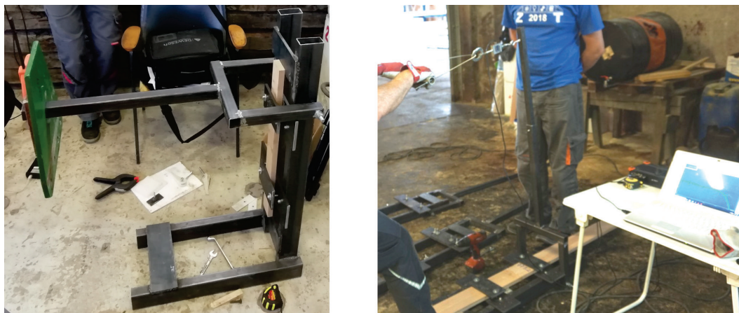
Slika 10. Naprava za izdelavo zobatih spojev (levo) in izdelava preizkušancev – stiskanje pod kontroliranim nanosom tlaka (desno).
