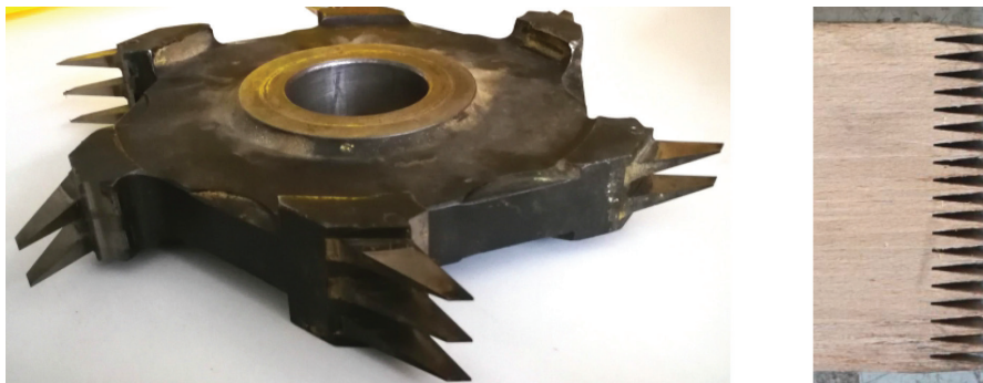
Slika 5. Rezkalni nož za 18 mm dolg zobati spoj (levo) in deska z 18 mm dolgim zobatim spojem (desno).
