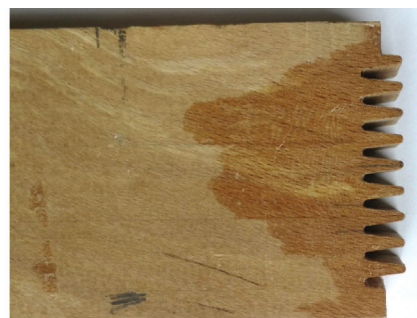
Slika 3. Rezkalni nož za 10 mm dolg zobati spoj (levo) in deska z 10 mm dolgim zobatim spojem (desno).
