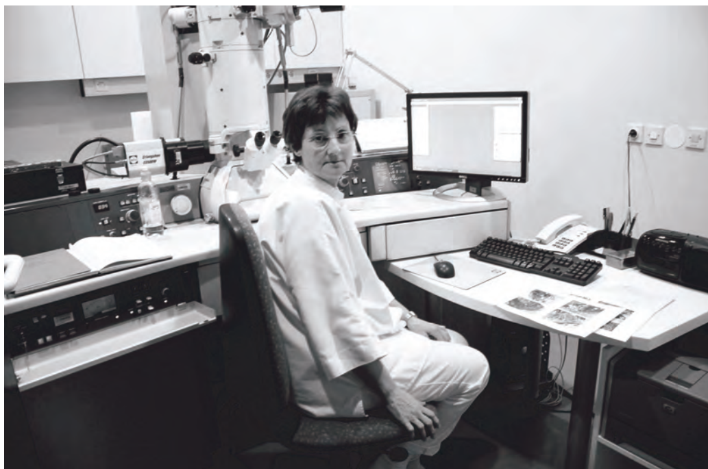
Pri analizi tkiva so včasih potrebne večje povečave, od 2.000- do 50.000-kratne, redkeje večje. Pri teh povečavah z elektronskim mikroskopom pregledamo pol mikrometra debele rezine (kar omogoča tako imenovani ultramikrotom).
