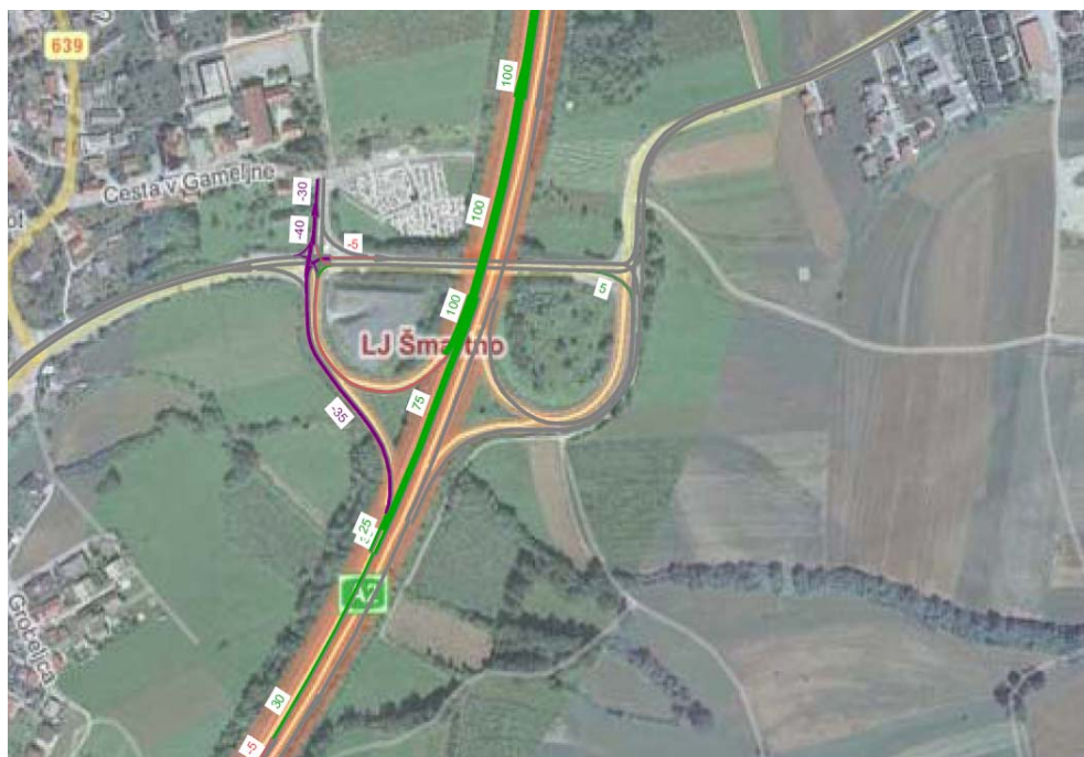
Slika 4-8: Priključek Šmartno, jutranja konica, leto 2010, primerjava povprečnih hitrosti vozil na omrežjih brez ukrepa nadzorovanega uvoza in z njim
