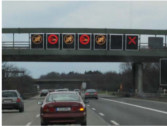
Slika 2-2: Primer ITS ukrepa uporabe odstavnega pasu na nemški avtocesti (pri Muenchnu)
