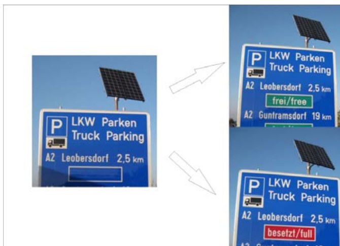
Slika 2-9: Primer ITS ukrepa razporejanja tovornih vozil, Avstrija (ASFINAG, 2011)
