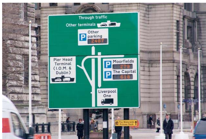
Slika 2-8: Primer ITS ukrepa upravljanja parkirišč, Dublin (Dambach, 2011)
