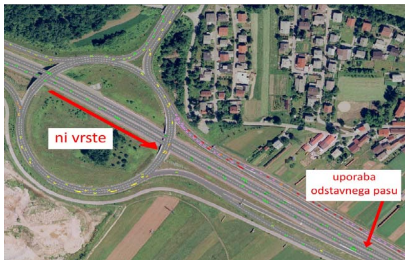
Slika 4-5: Krožišče Tomačevo, popoldanska konica, leto 2008, omrežje z ITS ukrepom spremenljive uporabe odstavnega pasu
