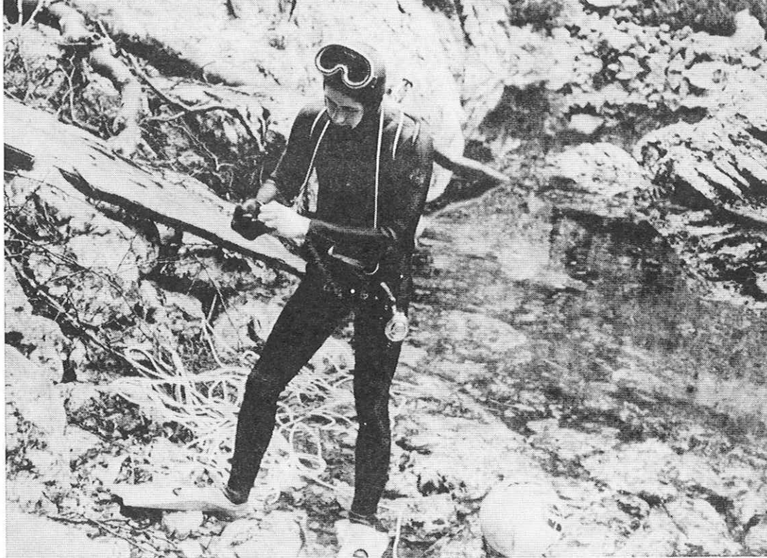
Po končanem potapljanju sva izmerila vrv, označeno z vozli, in tako ugotovila največjo globino jezera Foto Jože Hanc
