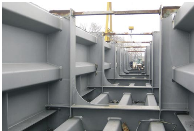
Segmenti, iz katerih bo sestavljen glavni razpon, so bili izdelani na Kitajskem
