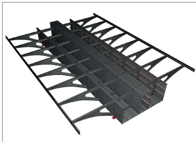
Slika 13 • Jekleni del sovprežne konstrukcije na grednem delu (rač. model za Sofistik)
