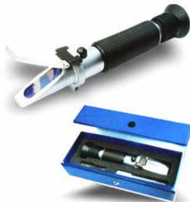
› Slika 8: Refraktometer je merilo, s katerim določamo različne karakteristike tekočih snovi, tudi kakovost hladilne tekočine.
