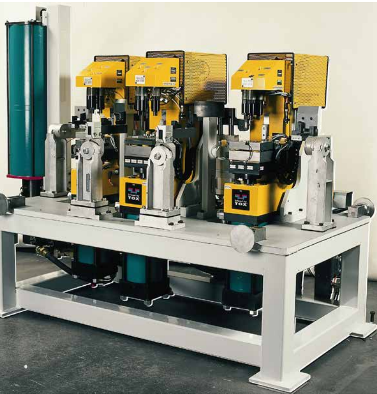
► Slika 4: Primer uporabe sistema TOX® KT iz specialne strojegradnje. Pretvornik tipa ES (levo) istočasno poganja tri delovne module AT (pod mizno ploščo)
