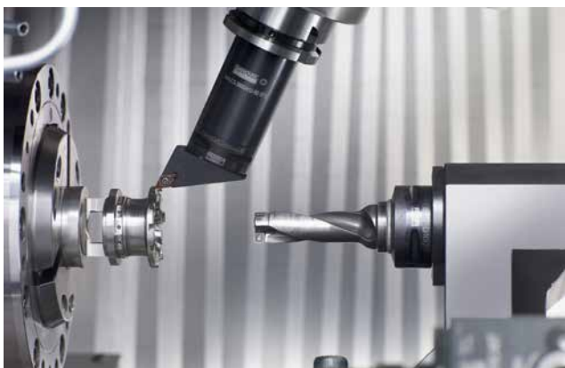
» Hibridni stroji, ki kombinirajo obdelavo s struženjem in rezkanjem ali druge tehnologije, potrebujejo zelo zmogljiva krmilja CNC.
