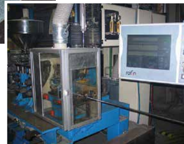
» Del linije, kjer se nasipa polnilo, trak dokončno formira v cev in lasersko zavari
