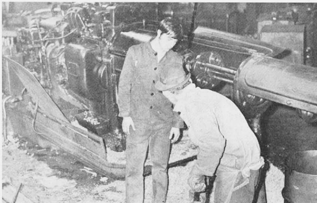
Vrtljivi deli pri strojih in napravah so vedno nevarni, zato je treba pri delu z njimi dosledno upoštevati vse varnostne ukrepe. Puščica na sliki prikazuje mesto, kjer je vrtljiva os zgrabila nezgodnico in jo skalpirala
