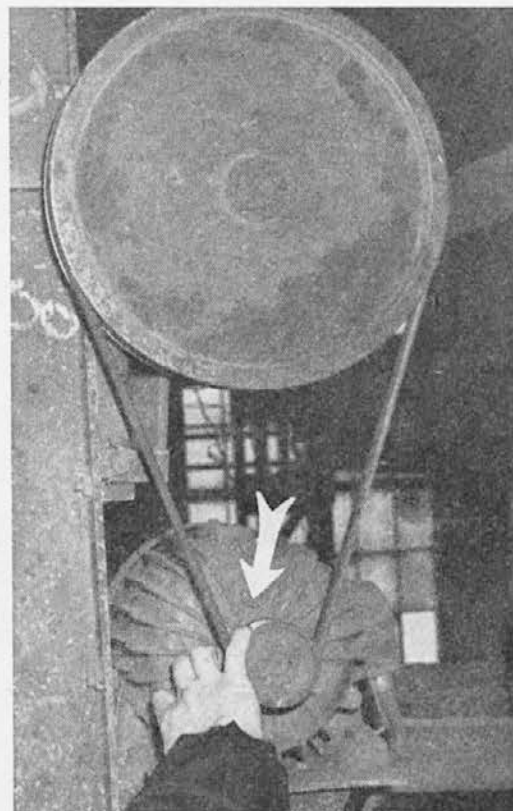
Nezavarovan pogonski jermen je poškodovan — ob dotiku z roko odrezal mezinček
