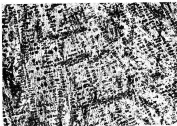
Slika 8 Povečava 40 \times , nital Vzorec št. 22; SL-18, ulito v kokilo H = 522, \lambda = 16,7 , c_p = 0,123 , \rho = 7,563 , a = 0,019
