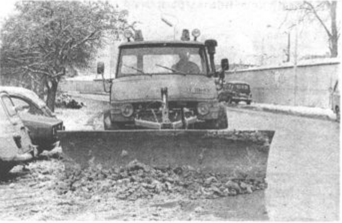
Unimog, s katerim lahko plug med vožnjo obračajo levo in desno, s tem pa je precej povečana njegova prilagodljivost
