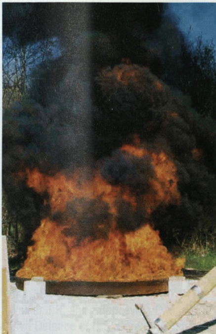
Slika 6: Oblika plamenskega telesa med požarnim testom in pripadajoča modelna simulacija pri hitrosti vetra v = 0 m/s 1 , porazdelitev temperature (°C) po kupoli je izračunana po 20 minutah simulacije
