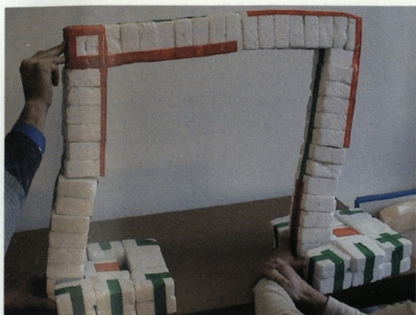
Slika 5: Vpeti okvir iz stiropornih kock pri horizontalni obtežbi (konstrukcijsko armaturo predstavlja rdeči lepilni trak)
