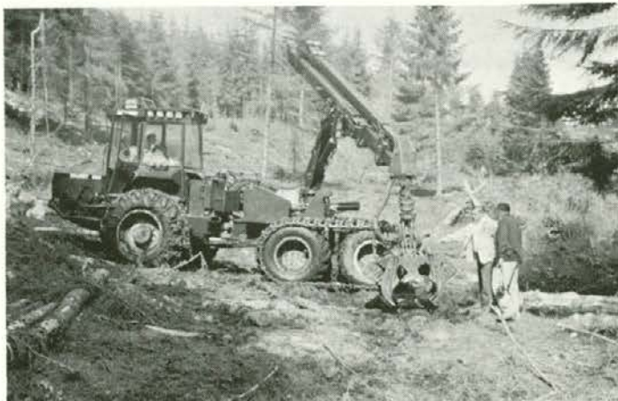
Processor Harvester za posek, kleščenje, krojenje, prežagovanje in sortiranje lesene mase
