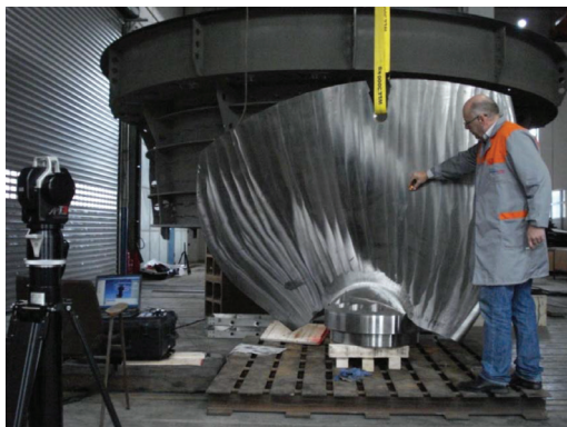
Slika 5: Merjenje gonilne lopate z laserskim sledilnikom API T3 (Ritlop et al., 2012).
