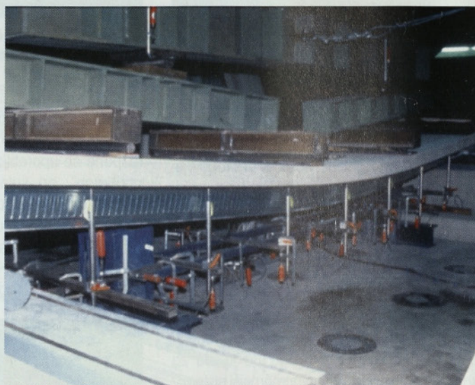
Slika 28 • Testiranje sovprežnega stropa
