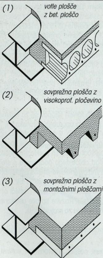
Slika 20 • Tipi stropov sistema "shallow floors"
