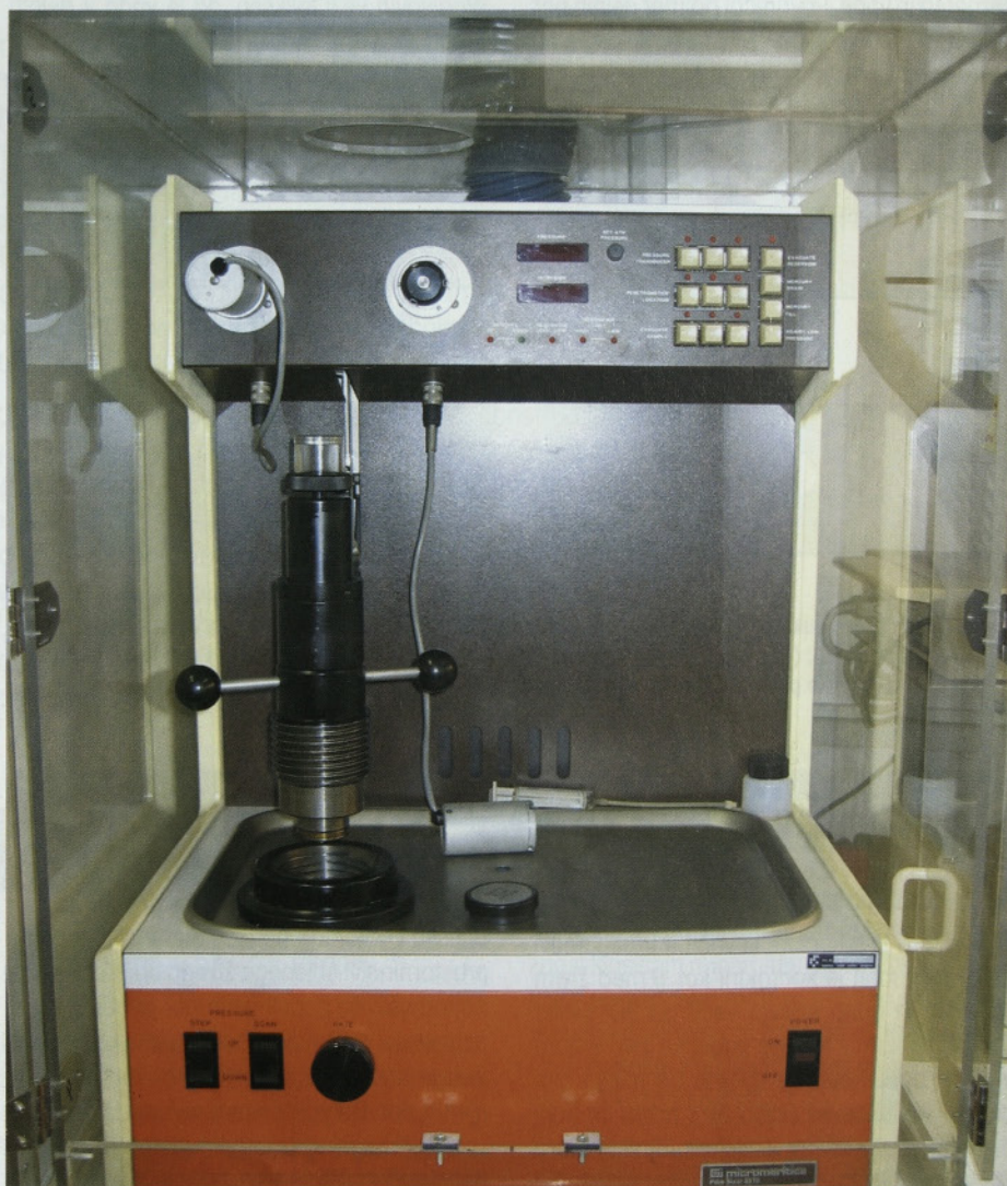
Slika 4 • Živosrebrni porozimeter MICROMERITICS Pore Sizer 9310
