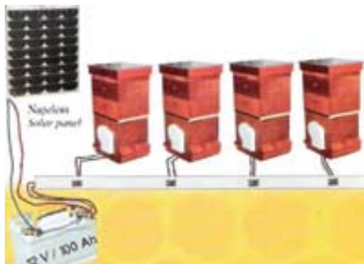
Primer priključitve panjev na akumulator, ki ga napaja sončna celica.
