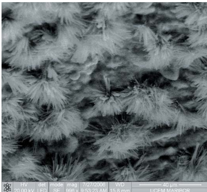
Slika 4 • Mikrostruktura cementnega kamna s pepelom tipa (b), povečana 996-krat
