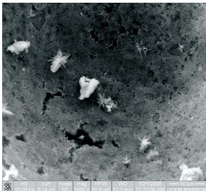
Slika 15 • Mikrostruktura preskušancev CI/DT po 121 dneh, povečana 5000-krat
