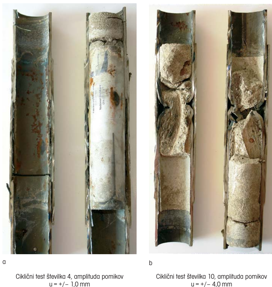
Slika 12 • Porušitev vzorcev v neto prerezu cevi; a) nepoškodovano betonsko polnilo; b) porušeno betonsko polnilo in lokalno izbočenje pločevine
