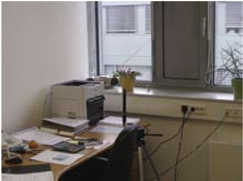
Slika 3. Merjenje toplotnega udobja s trifunkcijsko sondo
