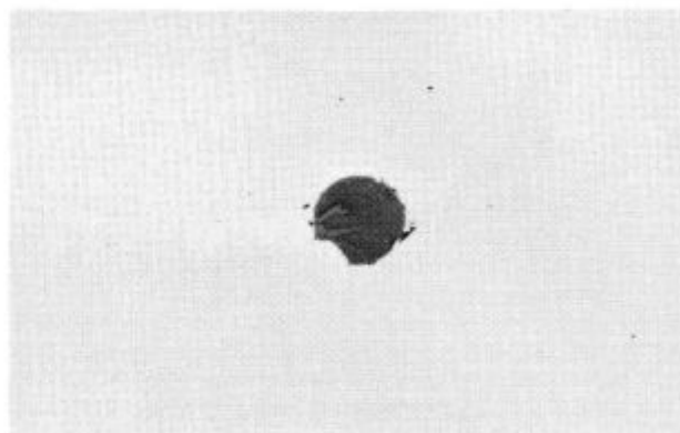
Slika 3 Kompleksen modificiran nekovinski vključek (pov. 100 ×) Fig. 3 Complex modified non-metallic inclusion (magn. 100 ×)
