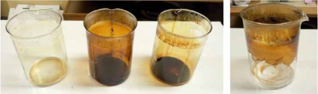
Slika 2 : Tvorjenje netopnih lakastih produktov na stenah čaš in usedlin na dnu [3]
