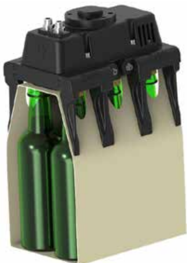
Prijemalo z občutkom, vendar dovolj zanesljivo, da dvigne karton s šestimi steklenicami
