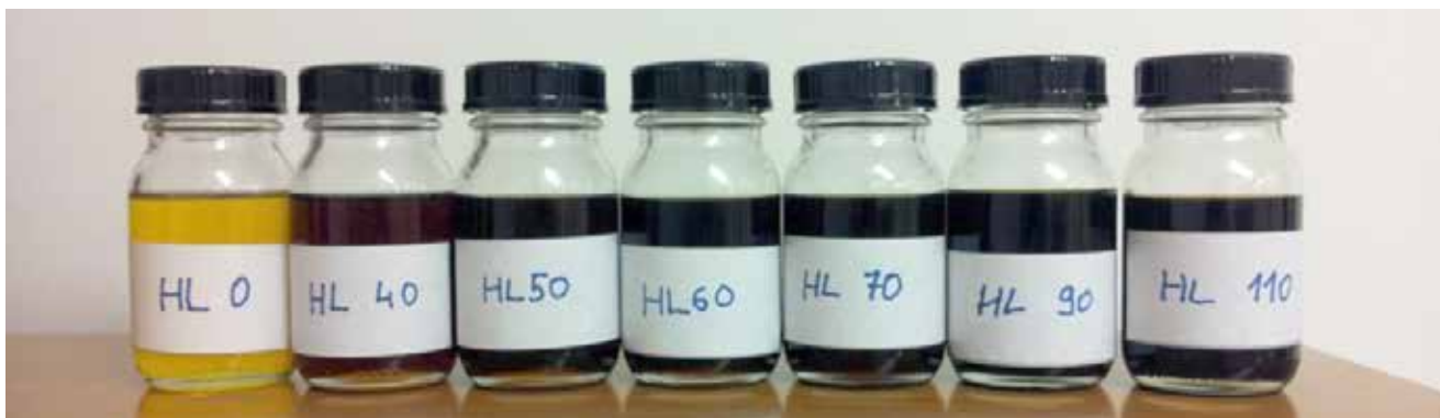
Slika 1: Sprememba barve olja zaradi termičnega obremenjevanja in oksidacije [2]
