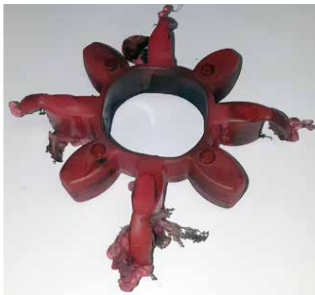
Slika 1 : Poškodovana parkljasta sklopka za pogon črpalke – pred odpovedjo
