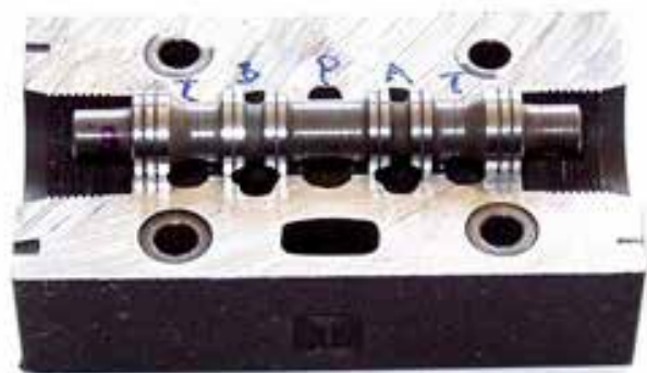
Slika 3 : Fotografija potnega ventila s slike 2 - v prerezu [2]
