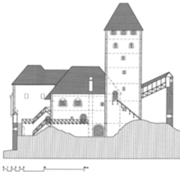
Naris severne fasade stavbnega sklopa na južni strani dvorišča gradu Rajhenburg. Poskus rekonstrukcije podobe okoli leta 1200 (risal Igor Sapač, 2012).
