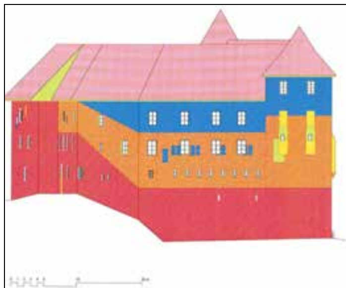
Izris južne grajske fasade z barvno označenimi hipotetičnimi razvojnimi fazami (po posnetku iz arhiva podjetja Gea Consult dopolnil Igor Sapač).
