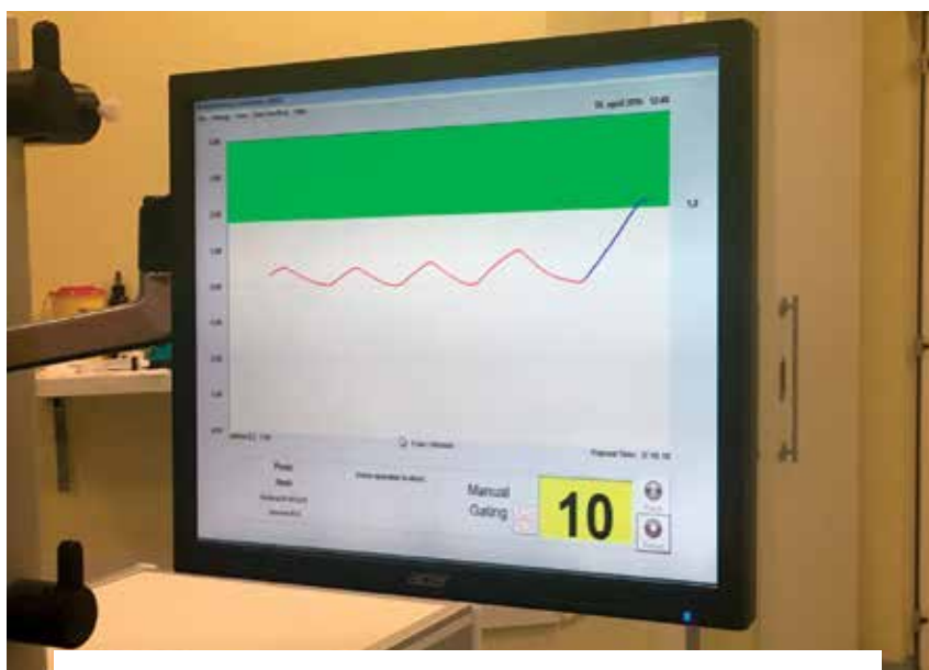
Zaslon ABC-sistema, ki ga med obsevanjem gleda bolnica. Na njem se izrisuje krivulja dihanja. Bolnico obsevamo, ko je krivulja v zelenem območju.
