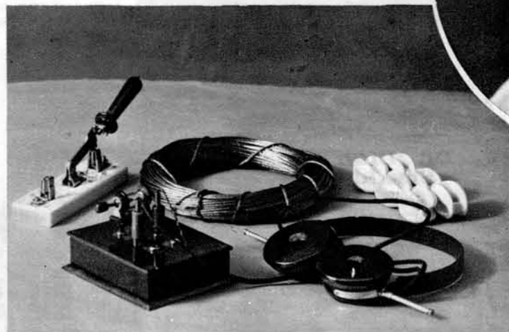
Najcenejši de-tek-torski apa-rat, uporabljen za okolico Domžal in stane z anteno ter slušalko vred 190 Din.
