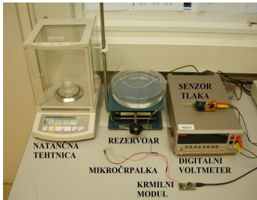
Slika 10: Sistem za računalniško vodenno karakterizacijo piezoelektričnih mikročrpalk
