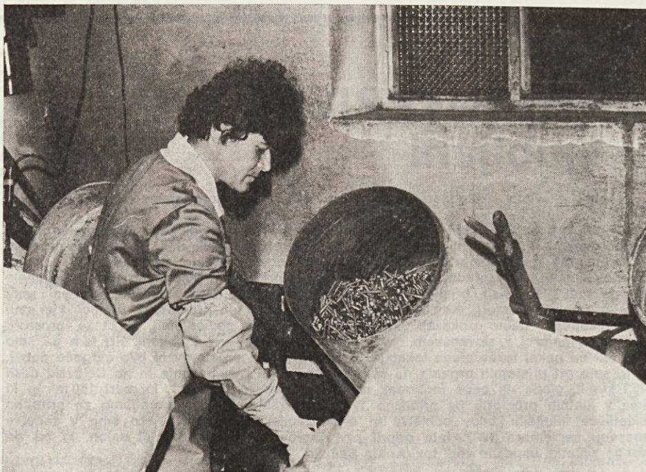
V oddelku površinske obdelave drobnih kovinskih polizdelkov terja delo natančnost in dosledno izpolnjevanje varnostnih predpisov
