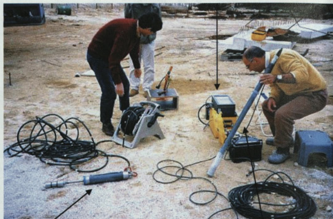
Slika 9 • Terenske preiskave za temelje pilotov mostu na avtocesti južno od Lizbone, »Cross-Hole« metoda (Lenart, 2003)
