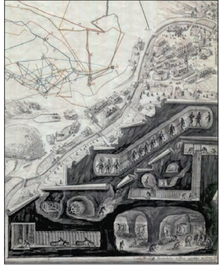
Fig. 1: Croquis de la mine de mercure d'Idrija et plan au sol d'Idrija, 1770, Jožef Mrak (Wikimedia Commons).
