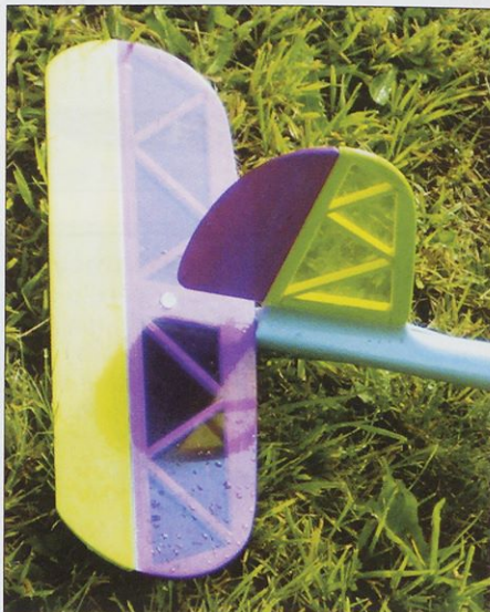
Eleganten način pritrditve višinskega stabilizatorja
