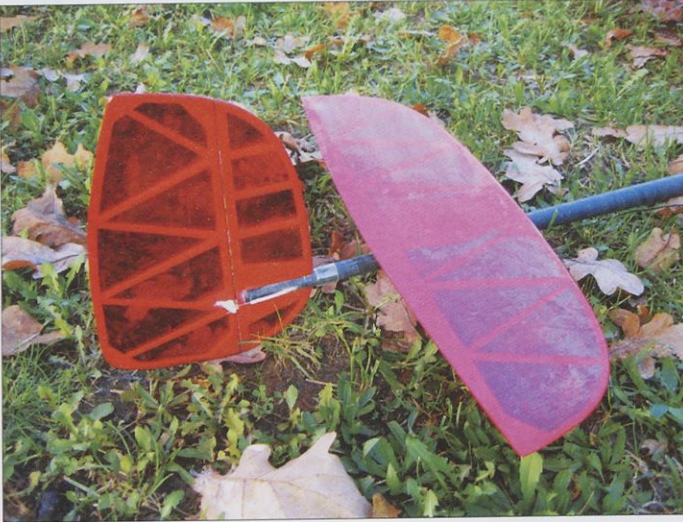
Smerni in višinski stabilizator sta povsem ločena. Velike površine omogočajo hitro in učinkovito krmiljenje modela po smeri in višini.
