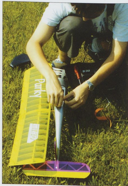
Krila modela so na trup pritrjena s pomočjo aluminijastega bajoneta in plastičnega vijaka.
