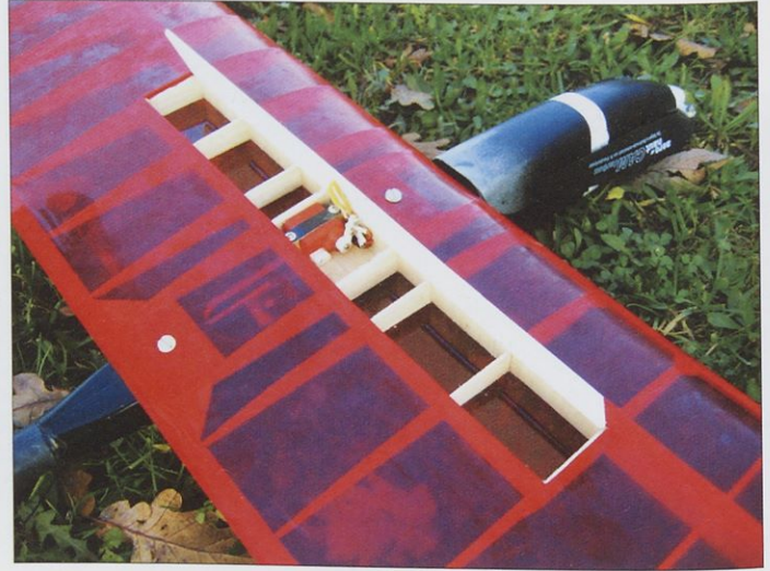
Servomehanizem za zračno zavoro je prilepljen v krilo. Polno izvlečenje zavora model učinkovito upočasni in mu poveča kot upadanja.
