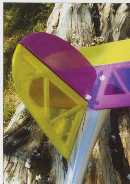
Detajl repa nam pokaže način povezave s smernim krmilom modela.
