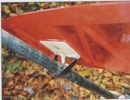
Izvedba plavajočega višinskega krmila, tokrat v tekmovalni izvedbi na lahkem trupu, katerega zadnji del je izdelan iz ogljikovih vlaken.
