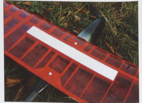
Krilo je na trup pritrjeno z dvema plastičnima vijakoma M 4. Zračna zavora na sliki je popolnoma uvlečena.
