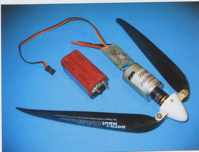
Tekmovalno konkurenčen pogonski sklop je sestavljen iz motorja razreda 400 s prenosom 4:1 in propelerjem 14 \times 10 . Napaja ga osem členov Ni-MH, KAN, 650 mAh.
