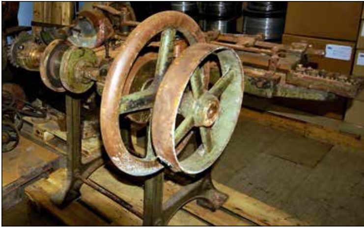
Stroj za izdelavo papirnih sponk pred obnovo.
