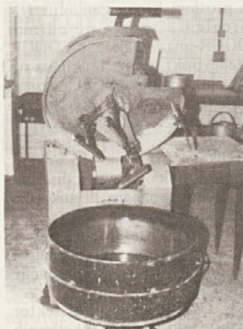
Laboratorijski mešalec za beton
