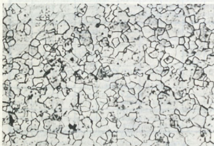
Metalografski posnetek mikrocinca - povečava mikrostrukture 100 krat
