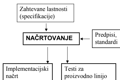
Slika 1.14 Pri masovni proizvodnji potrebujemo tudi teste za proizvodno linijo
