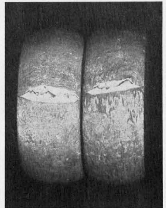
Slika 4 — slabi krčilni probi, ki sta popokali zaradi slabe površine
