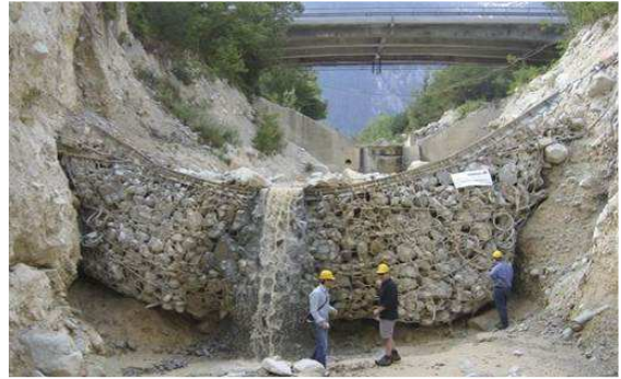
Slika 4: Lovilna pregrada po izvedenem testu
