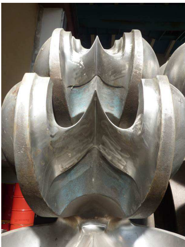
Slika 15: Gospodar Energije – Turbinske lopatice novega gonilnika HE Peručica (dobava Litostroj Power)
