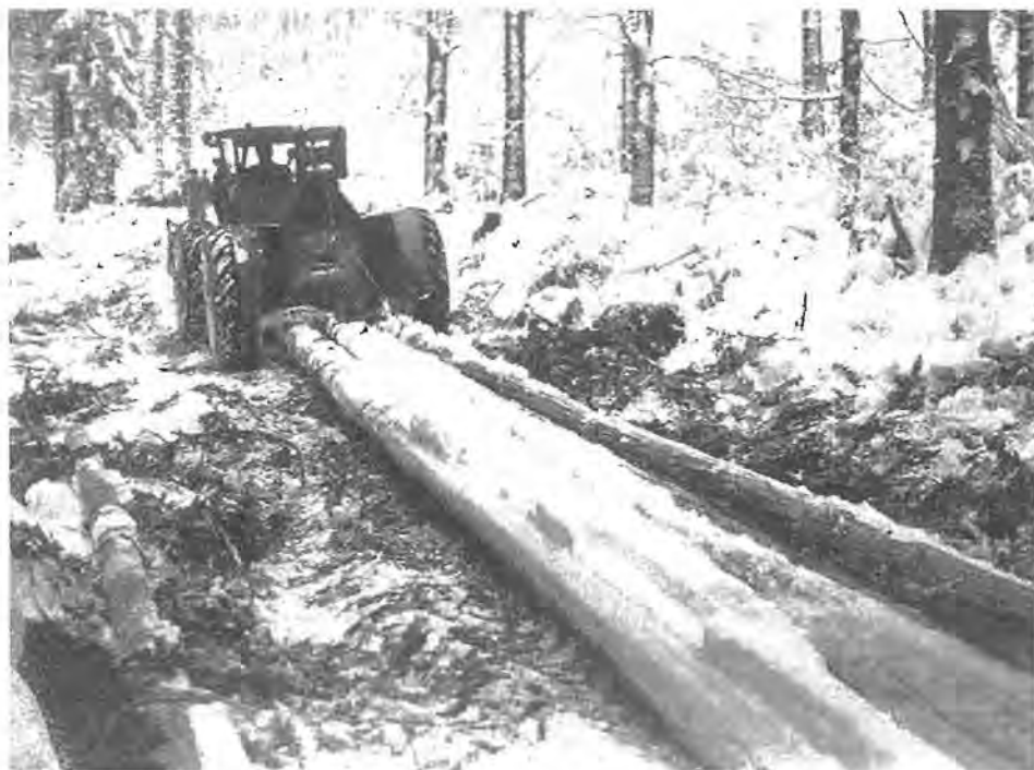
Slika 3. Po vlakah, pokritih s snegom, lahko s traktorjem vlačimo les kilometre daleč, ne da bi poškodovali tla in les
