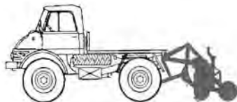
Unimog s frezo dela temeljito
