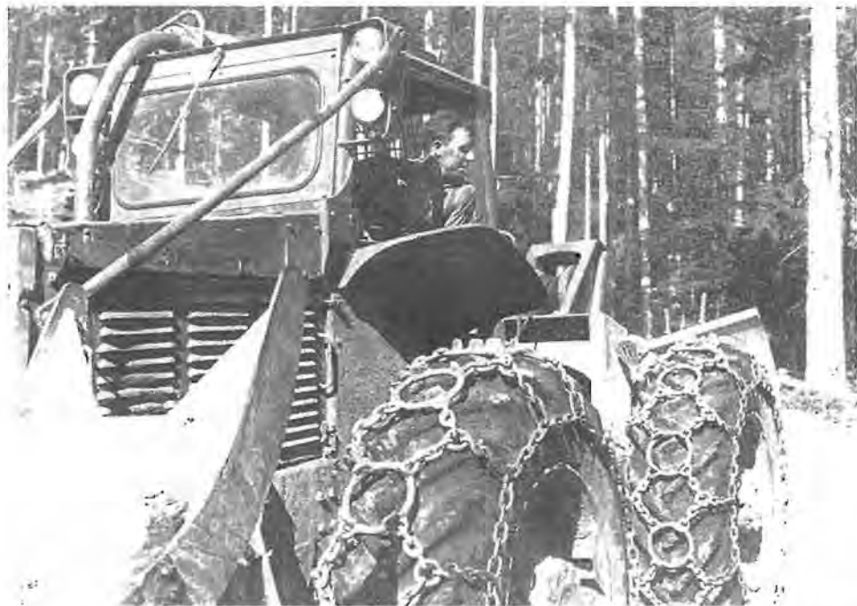
Slika 5. Grabilne kolesne verige zgibnega traktorja omogočajo povečanje koristnega bremena do 20%, toda pogosto v škodo gojenja gozdov
