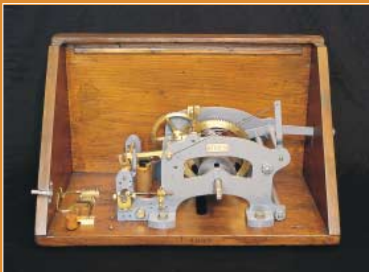
Mehanični pogon (z utežjo) za veliki signalni zvonec, kakršni so bili nekoč montirani vzdolž proge. Prometniki so z njimi najavljali čuvajem odhode vlakov s postaj in njihovo smer vožnje.
