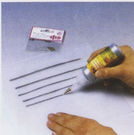
Slika 2. Konturne črte lahko izdelate posebej na foliji ali polietilenski delovni plošči ...
