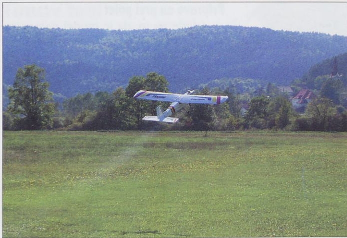
Zaradi močnega motorja in propelerja z manjšim korakom je kot vzpenjanja pri vzletanju že pri dveh tretjinah plina precej strm.
