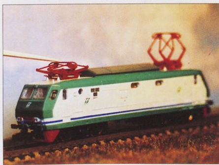
Zgornji odzemnik je kovinski in se ob preobremenitvi spusti. Za dvig skrbita dve vijačni vzmeti.
