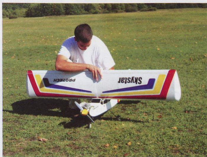
Čeprav je dobro imeti pomoč, model brez težav sestavimo sami. Če servomehanizma za nagib ne želimo priključiti neposredno na sprejemnik, potrebujemo krajši podaljšek.
