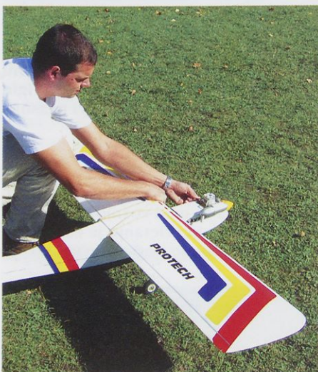
Motor pri polnem plinu vedno nastavljamo z zadnje strani modela! Protech .46 SX ima t. i. varnostno iglo, da imamo pri nastavljanju prste daleč stran od propelerja.
