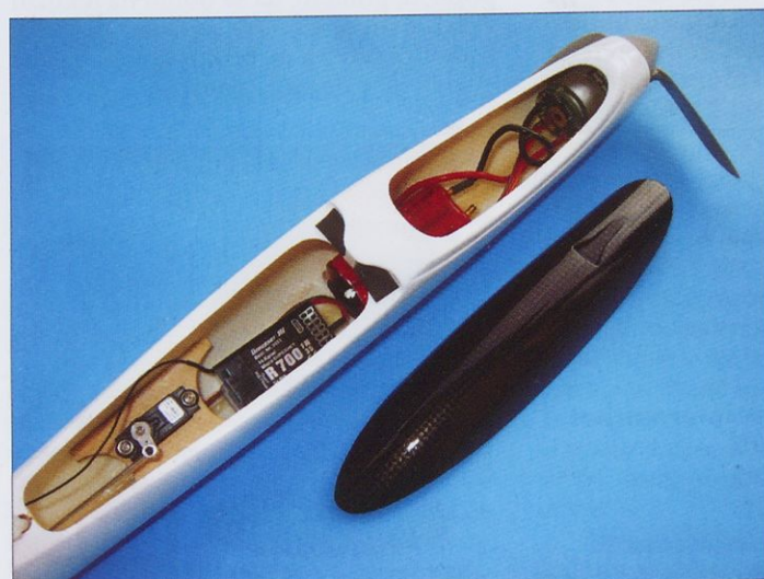
Čeprav model ni med največjimi, je v trupu več kot dovolj prostora za vse RV-komponente. Mizico servomehanizma višine sem precej zmanjšal in s tem še pridobil na prostoru.
