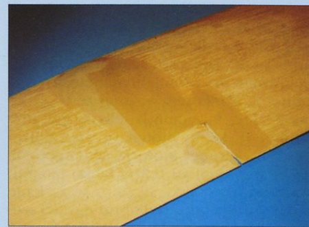
Da dosežemo brezhibno površino, kitamo postopoma po majhnih korakih, tako da brušenja ni prav dosti.
