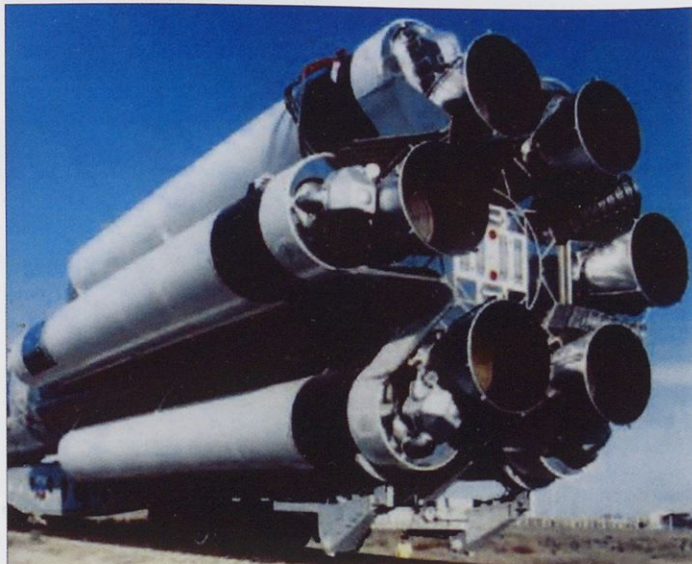
Stranski blok prve stopnje z motorjem RD-253
