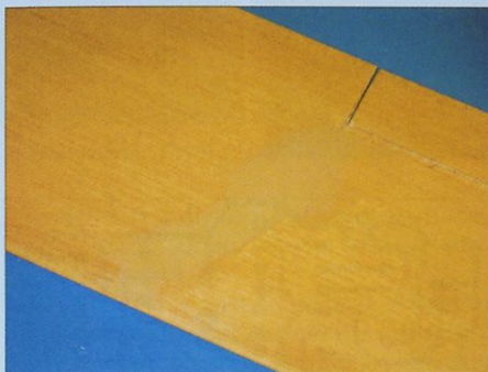
Ko krilo poravnamo, s spodnje strani vstavimo nadomestni nosilec, ki ga vlepimo z zmesjo epoksidne smole in bombaža. Spoj prebrusimo in pokitamo.
