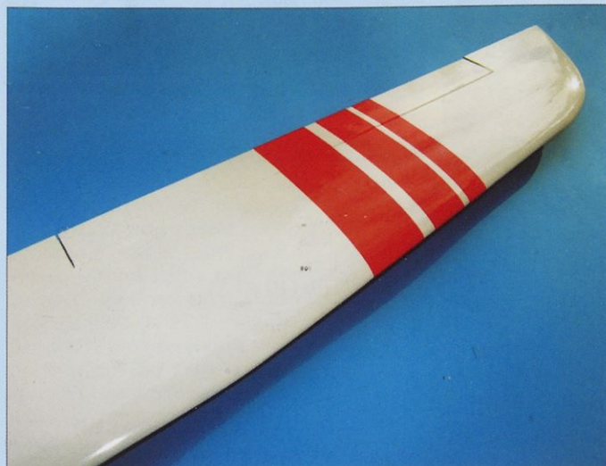
Ko krilo poravnamo, s spodnje strani vstavimo nadomestni nosilec, ki ga vlepimo z zmesjo epoksidne smole in bombaža. Spoj prebrusimo in pokitamo.
