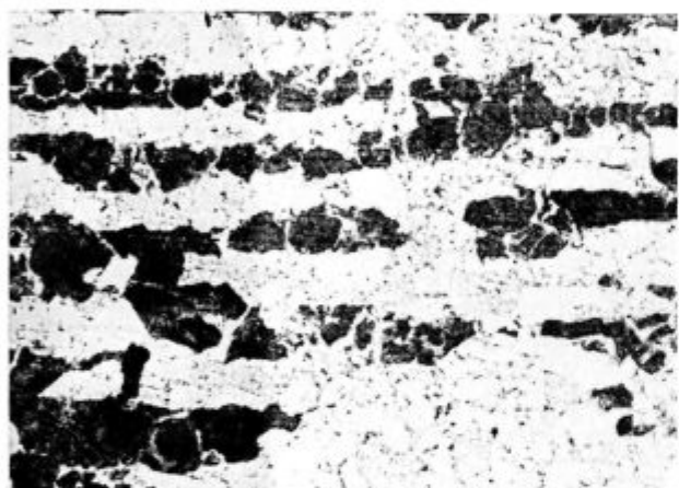
Slika 9 b Talina 4, 1050° C, velikost sekundarnega zrna 6 ASTM, trakavost 4
