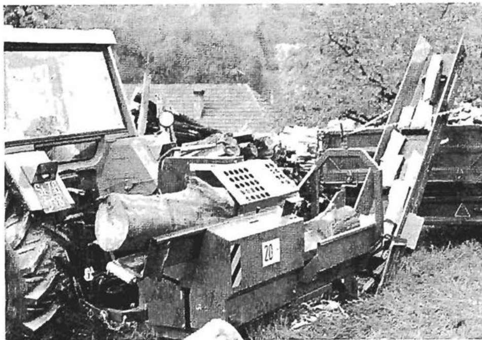
Sl. 6a: Kombiniran stroj: žaga-cepilka s transporterjem za nakladanje (odmikanje) polen
