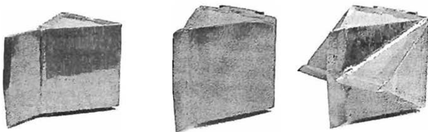
Sl. 4a, b, c: Različni tipi hidravličnih cepilk. a: Težja cepilka, traktorski priključek z možnostjo cepljenja v vodoravnem in navpičnem položaju
