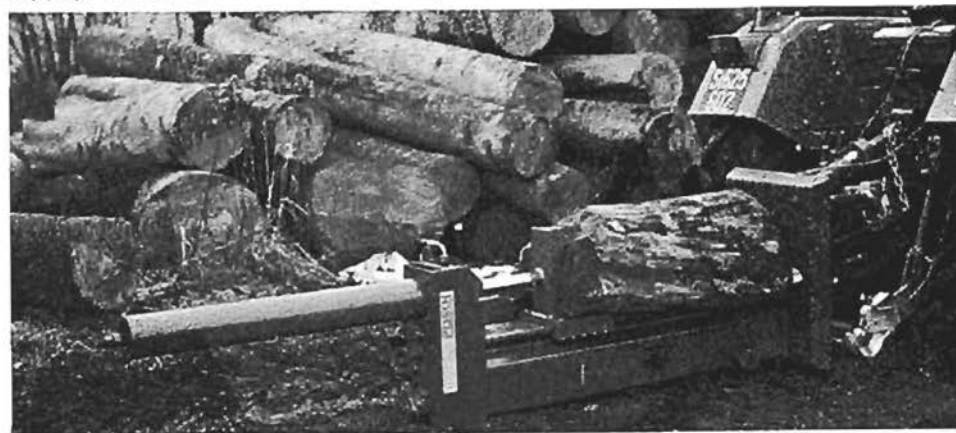
Sl. 4a, b, c: Različni tipi hidravličnih cepilk. a: Težja cepilka, traktorski priključek z možnostjo cepljenja v vodoravnem in navpičnem položaju
