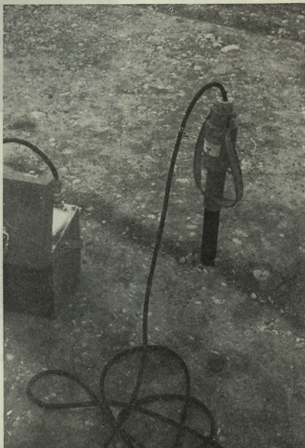
Sl. 1. Aparatura za globinsko merjenje vlage in gostote z radioaktivnimi izotopi
