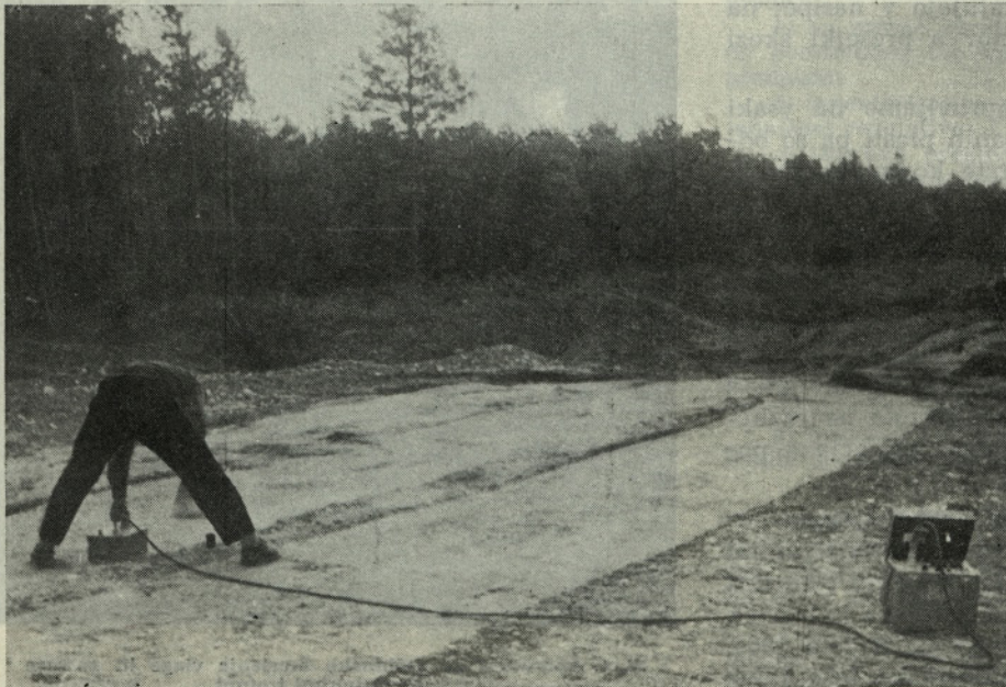
Sl. 3. Meritve gostote in vlage s površinsko sondo
