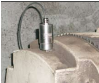
Slika 3. Ultrazvočni senzor Ultra Trak 750 (a) in namestitev na okrov stroja (b)
