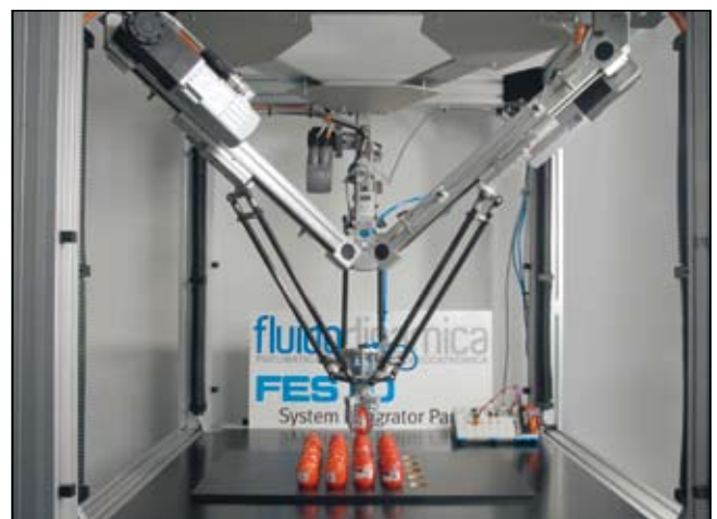
Prebiranje čokoladnih jajčk s tripodnim robotom in bionskim prijemalom (foto: Festo)
