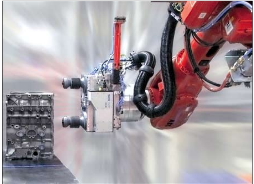
SICK-ova pametna kamera IVC-3D je vgrajena neposredno na robotsko roko in omogoča določitev koordinat predmeta v 3D-prostoru
