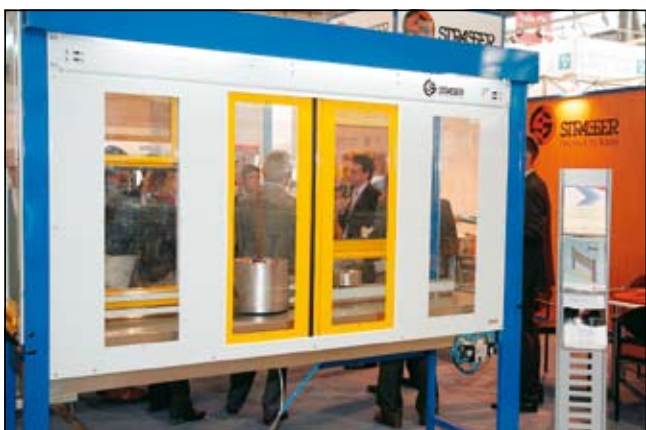
Poseben mehanizem za hitro ustavitev gibanja vrat podjetja Strasser omogoča hitro zapiranje s pnevmatiko podjetja Festo
