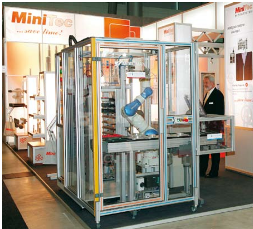
Sedemosni robot za prilagodljivo in učinkovito strego obdelovalnemu stroju
