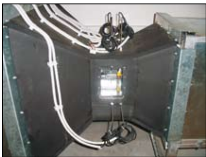
Slika 4a. Merilna proga LPT – detajli kanalskega dela: izstopna mreža tipal, merjeni PT in vstopna mreža tipal (smer zraka je iz desne proti levi)
