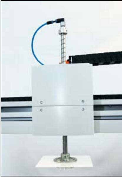
Dvižno-obračalni modul z velikimi hitrostmi in prijemanjem brez dotika za rokovanje z električnimi sončnimi moduli (foto: Festo)
