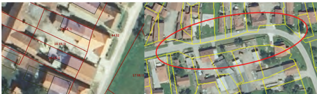
Slika 1: Neskladje med DKN in DOF na levi ter anomalije na stikih listov na desni.
