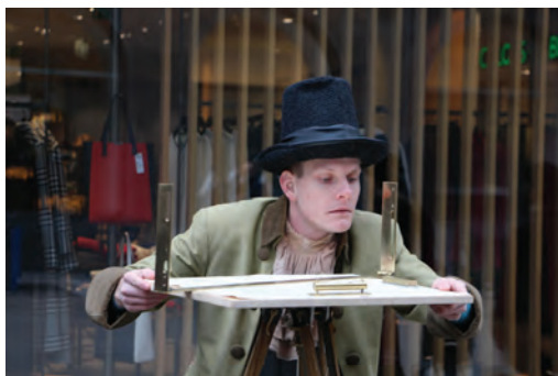
Slika 5: Prikaz katastrske izmere – kartiranja – z mersko mizico, Jernej Tekavec.
